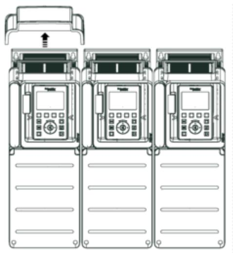
**Tipo di montaggio C: singolo IP20**
