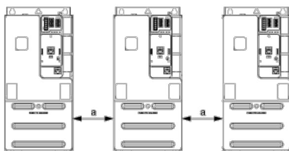
a ➤ 50 mm (1,97 pollici) da  $50\ldots60^{\circ}\text{C}$ , nessuna restrizione sotto  $50^{\circ}\text{C}$
