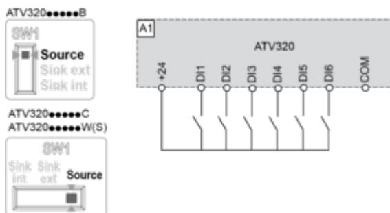
Commutatore SW1 impostato in posizione "Source" e utilizzo di un'alimentazione esterna per gli ingressi digitali.
