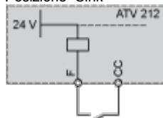
Posizione "PLC" con uscite transistor PLC
