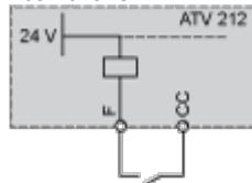
Posizione "PLC" con uscite transistor PLC
