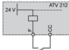
Posizione "PLC" con uscite transistor PLC
