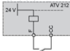
Posizione "PLC" con uscite transistor PLC
