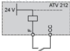
Posizione "PLC" con uscite transistor PLC
