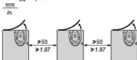
Rimuovendo il coperchio protettivo dalla parte superiore del variatore, il grado di protezione del variatore diventa IP21. Il coperchio protettivo può variare in base al modello di variatore, vedere a fianco.
