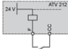
Posizione "PLC" con uscite transistor PLC
