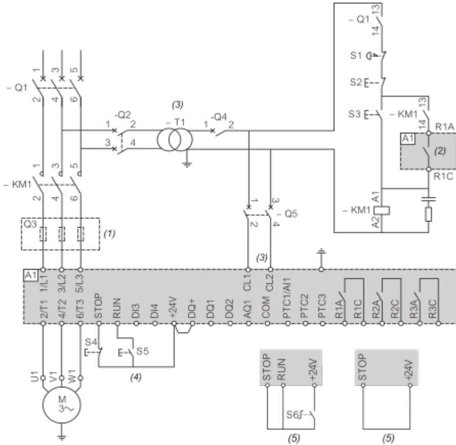
(1) : Installazione di fusibili ad azione rapida supplementari per l'aggiornamento al coordinamento di tipo 2 in base a IEC 60947-4-2.
