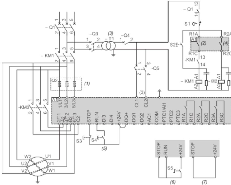
(1): Installazione di fusibili ad azione rapida supplementari per l'aggiornamento al coordinamento di tipo 2 in base a IEC 60947-4-2.
