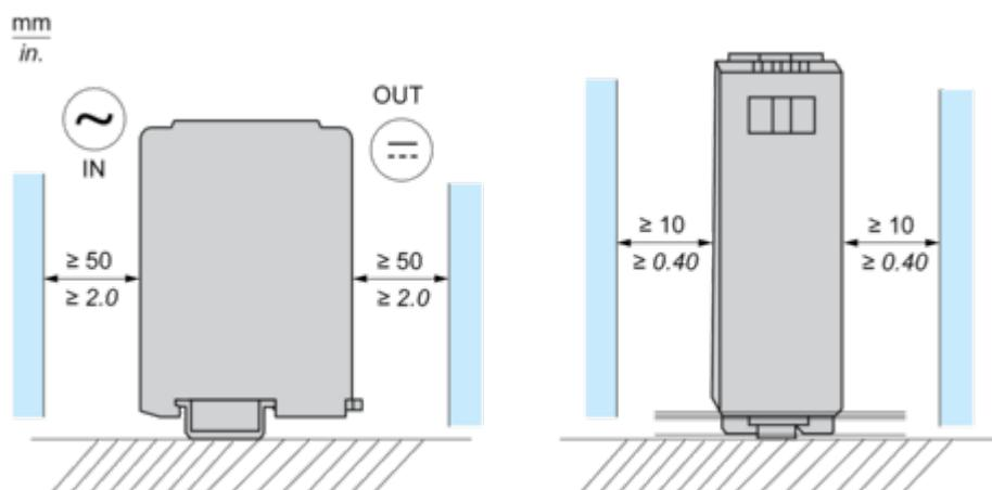
**Posizione di montaggio errata**
