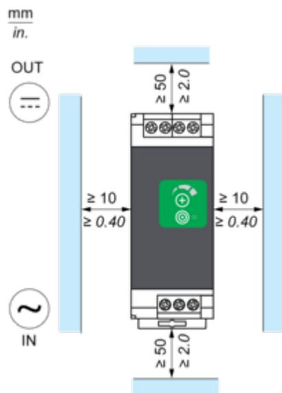
**Posizione di montaggio B**
