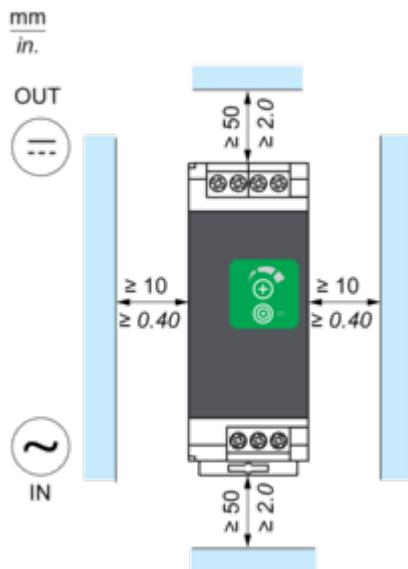
**Posizione di montaggio B**
