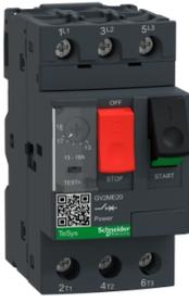
Interruttore automatico magnetotermico GV2ME con controllo a pulsante e range regolazione protezione termica da 13 A a 18 A, 3P, connessione a vite
