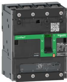
Interruttore, ComPacT NSXm 100B, 25kA/415VAC, 4 poli 3D (neutro non protetto), Sganciatore TMD 25A, busbar/connettori
