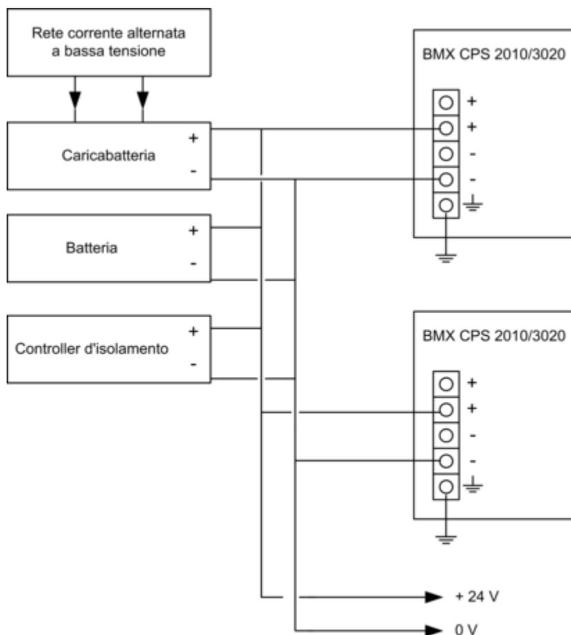
Rete a tensione variabile 24 VDC per alimentazione sensori, attuatori e moduli di I/O.
