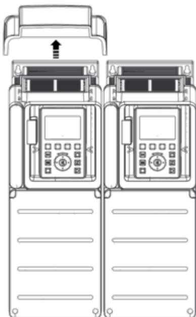
Tipo di montaggio C: singolo IP20
