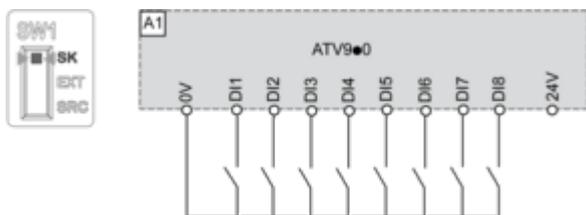
**Commutatore impostato in posizione EXT utilizzando un'alimentazione esterna per gli ingressi digitali**
