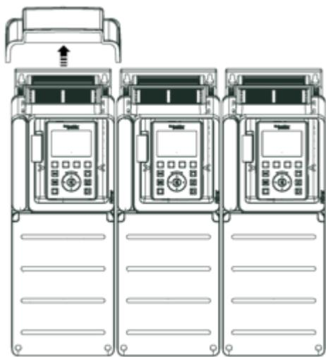
**Tipo di montaggio C: singolo IP20**
