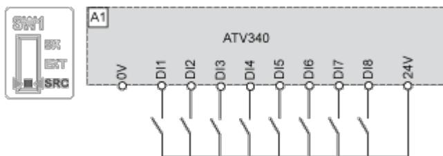
Commutatore impostato in posizione SRC (Source) e utilizzo di un'alimentazione esterna per gli ingressi digitali
