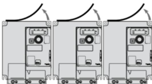
**Montaggio tipo C: singolo, coperchio ventilazione rimosso**
