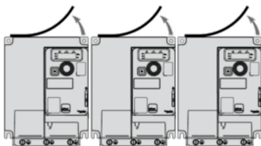
**Montaggio tipo C: singolo, coperchio ventilazione rimosso**
