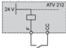
Posizione "PLC" con uscite transistor PLC
