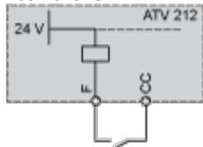
Posizione "PLC" con uscite transistor PLC
