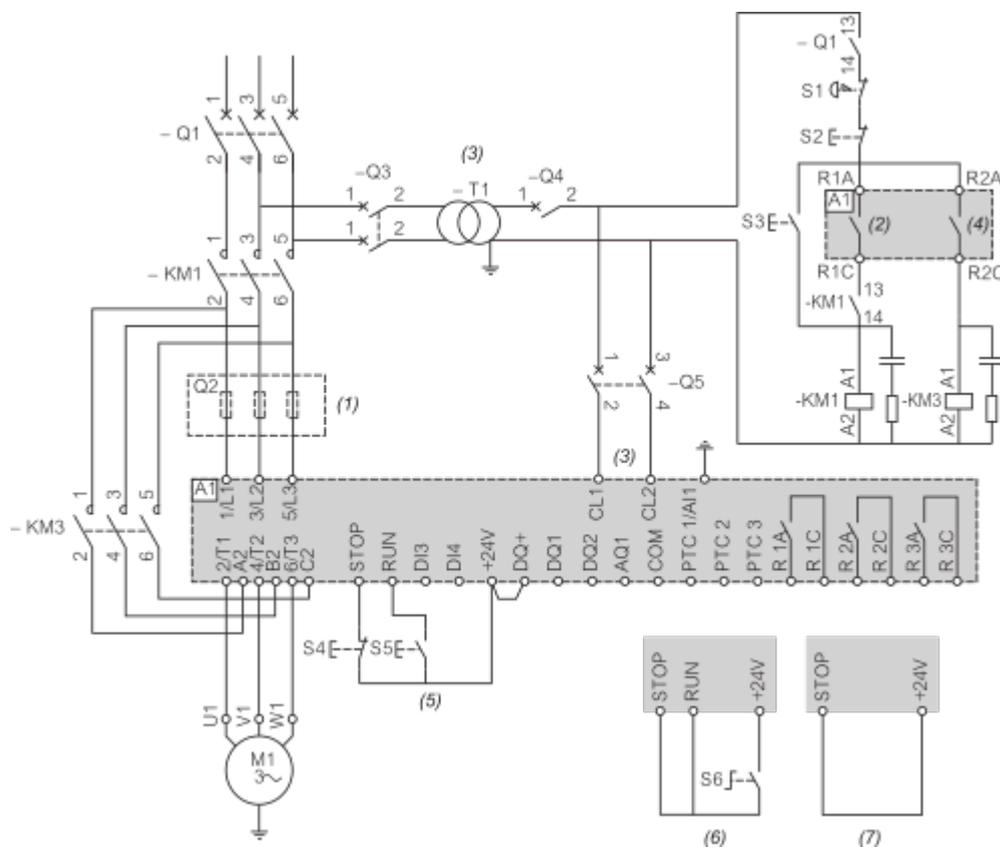
(1): Installazione di fusibili ad azione rapida supplementari per l'aggiornamento al coordinamento di tipo 2 in base a IEC 60947-4-2.
