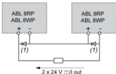
(1) Due diodi Shottky I<sub>min</sub> = alimentatore I<sub>n</sub> e V<sub>min</sub> = 50 V
