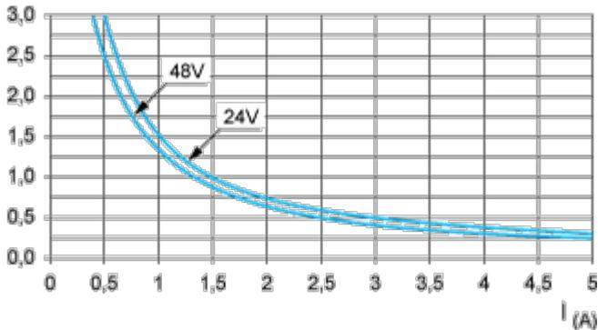
DC12 controllo di carichi resistivi e di carichi allo stato solido isolati da accoppiatore ottico,  $I/R \leq 1$  ms.
