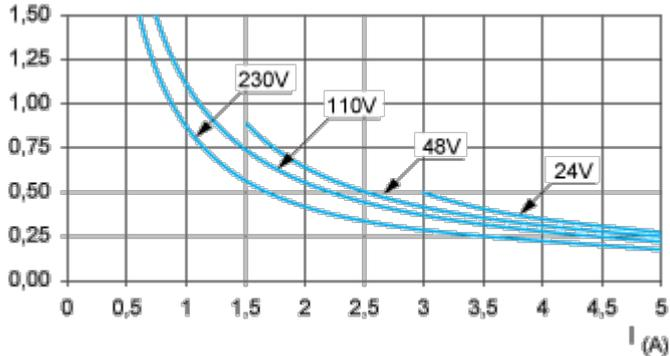
AC15 controllo di carichi elettromagnetici  $> 72$  VA, chiusura (make):  $\cos \phi = 0,7$ , interruzione (break):  $\cos \phi = 0,4$ .
