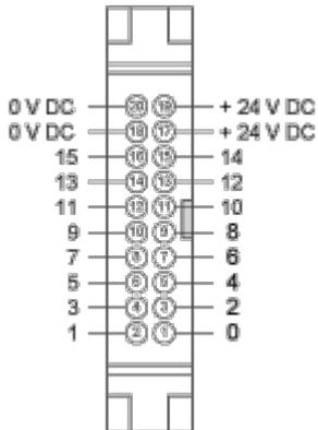
Schema di cablaggio
