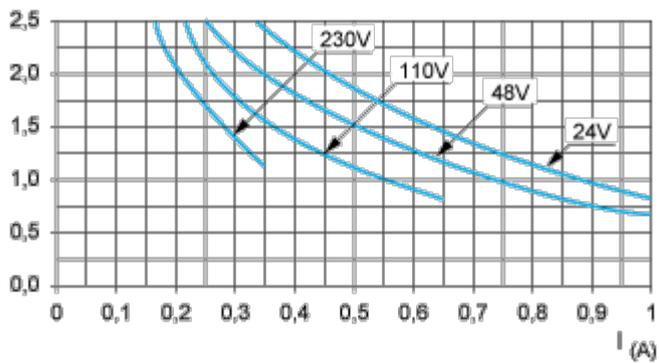
AC14 controllo di piccoli carichi elettromagnetici  $\leq 72$  VA, chiusura (make):  $\cos \phi = 0,3$ , interruzione (break):  $\cos \phi = 0,3$ .
