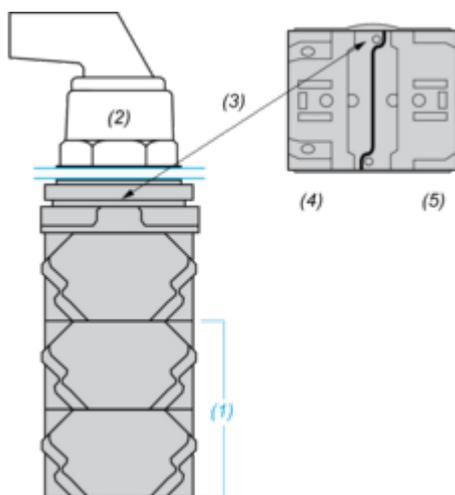
(1) È possibile montare fino a 3 livelli di blocchi contatti (max di 6 blocchi)
