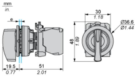
e: Spessore fissaggio: da 1 a 6 mm / da 0.04 a 0.24 in.
