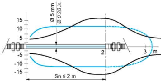
Curve guadagno eccesso (Temperatura ambiente:  $\pm 25^{\circ}\text{C}$ )
