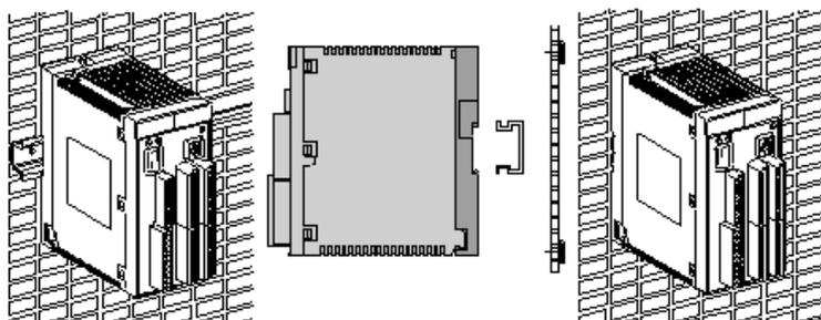
Adattatore di metallo per fissaggio su metallo: guida DIN 35 mm/1.38 in.
