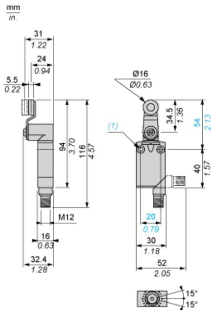
(1) 2 fori di fissaggio  $\varnothing 4,2$  mm, incasso  $\varnothing 8$  mm e 4 mm di profondità
