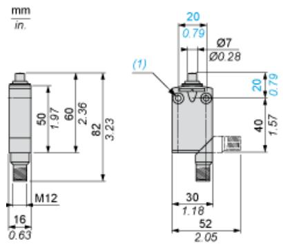
(1) 2 fori di fissaggio Ø 4,2 mm, incasso Ø 8 mm e 4 mm di profondità
