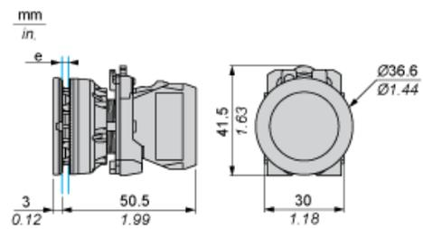
e: Spessore fissaggio: da 1 a 6 mm / da 0.04 a 0.24 in.
