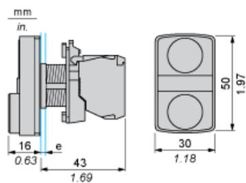
e: spessore fissaggio: da 1 a 6 mm / da 0,04 a 0,24 in.
