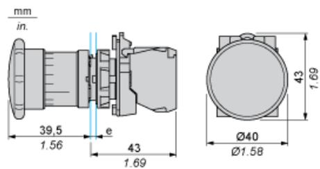
e: spessore fissaggio: da 1 a 6 mm / da 0,04 a 0,24 in.
