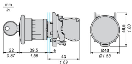
e: spessore fissaggio: da 1 a 6 mm / da 0,04 a 0,24 in.
