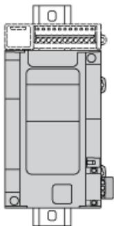
NOTA: I moduli di espansione devono essere montati sopra il logic controller.
