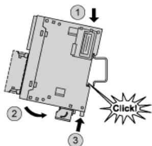
Montaggio diretto sulla superficie di un pannello
