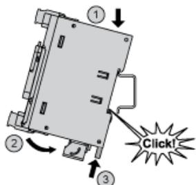
Montaggio diretto sulla superficie di un pannello
