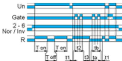
$T_{on} = t_1 + t_2 + t_3$
