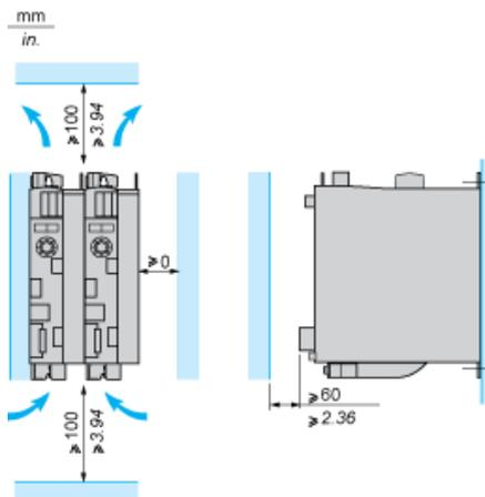
I servoazionamenti LXM32•U45M2, •U90M2 e LXM32•U60N4 vengono raffreddati tramite convezione naturale. I servoazionamenti LXM32•D18M2, •D30M2, LXM32 •D12N4, •D18N4, •D30N4 e •D72N4 sono dotati di una ventola integrata.
