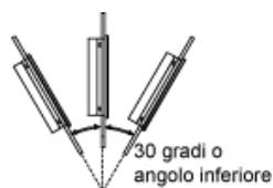
Quando si installa questo prodotto in posizione inclinata con angolo maggiore di 30°, la temperatura ambiente non deve superare 40 °C (104 °F). Potrebbe essere necessario l'uso di aria di raffreddamento forzata (ventilatori, A/C) per assicurare che la temperatura ambiente sia al massimo 40°C (massimo 104°F).
