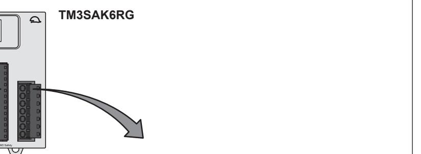
Screw terminal blocks 5.08 mm (0.20 in.) pitch / Borniers à vis pas de 5.08 mm
