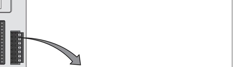
Screw terminal blocks 5.08 mm (0.20 in.) pitch / Borniers à vis pas de 5.08 mm
