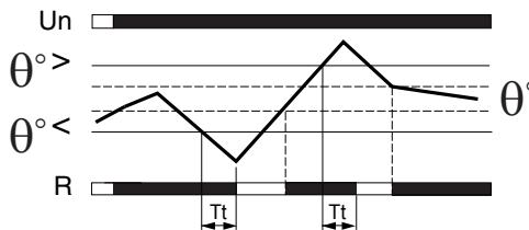
T<sub>t</sub> : time delay on opening, after threshold overshoot (adjustable on front panel) / T<sub>t</sub> : temporisation à l'ouverture après franchissement du seuil de température (réglable en façade)
