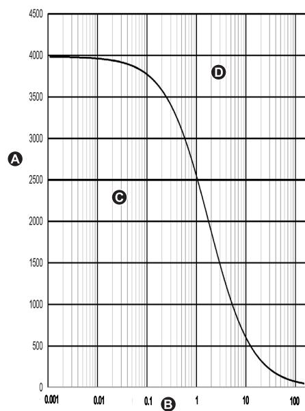
**pt** Gráfico de resistência versus capacidade do sistema para os valores de limiar do dispositivo.
