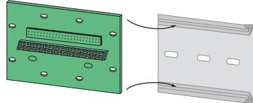
Strain relief / Descarga de tracción / Serre-câble / Zugentlastung / Разгрузка натяжения кабеля / 应变消除
