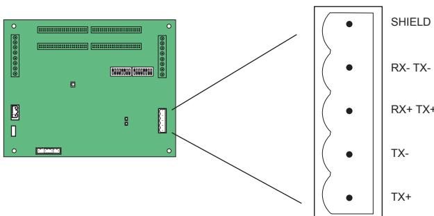
BCPMSCA/B/C and BCPMSCxY63S 2-Wire Configuration / BCPMSCA/B/C y BCPMSCxY63S Configuración de 2 Cables / BCPMSCA/B/C et BCPMSCxY63S Configuration 2 fils / BCPMSCA/B/C und BCPMSCxY63S 2-Drahtkonfiguration / 2-проводная конфигурация BCPMSCA/B/C и BCPMSCxY63S / BCPMSCA/B/C и BCPMSCxY63S 2线配置
